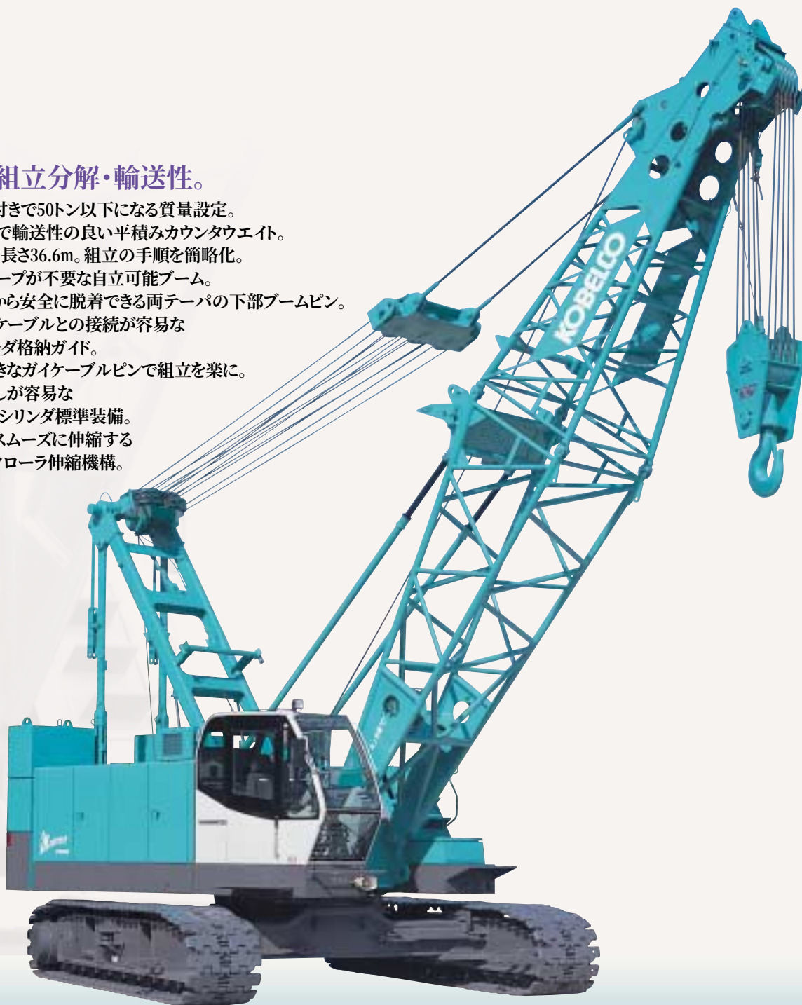
輸送に配慮した クローラ縮小時全幅3.2m。
